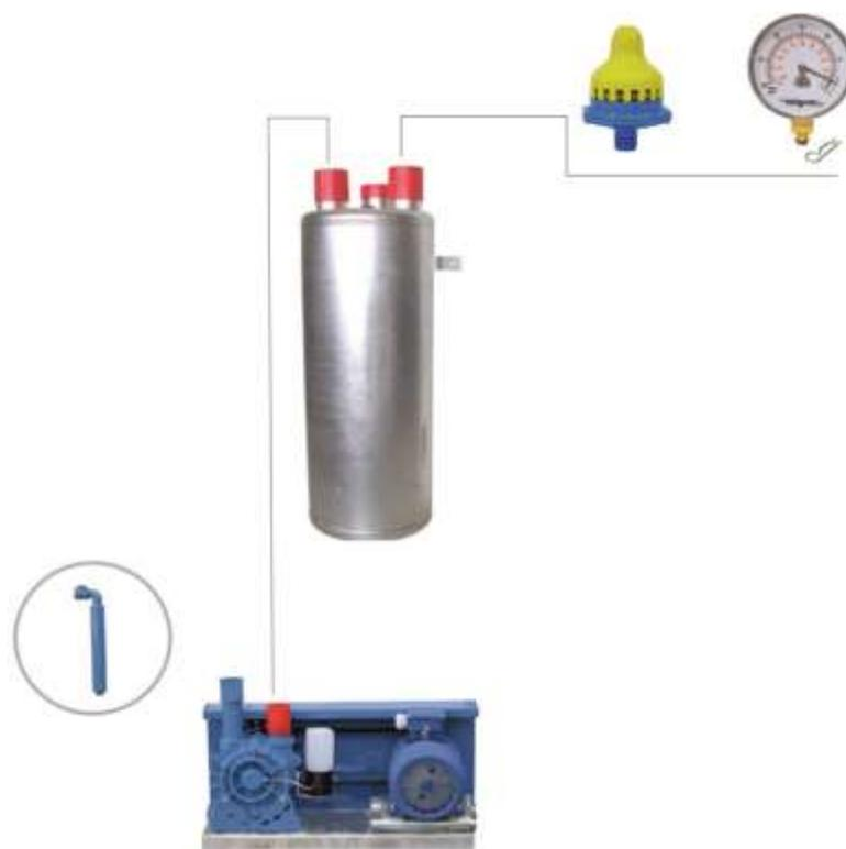
На каждой вакуумной станции устанавливается свой регулятор вакуума, манометр и ресивер объемом 100 л.
