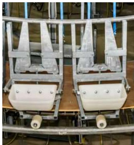
Каждое доильное место укомплектовано пластиковой кормушкой. Их прочная конструкция соответствует требованиям современных животноводческих ферм и обеспечивает требуемую прочность.
